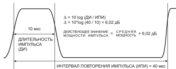
Рис. 1. Использование измерителя средней мощности для определения импульсной мощности (действующего значения мощности импульса)
